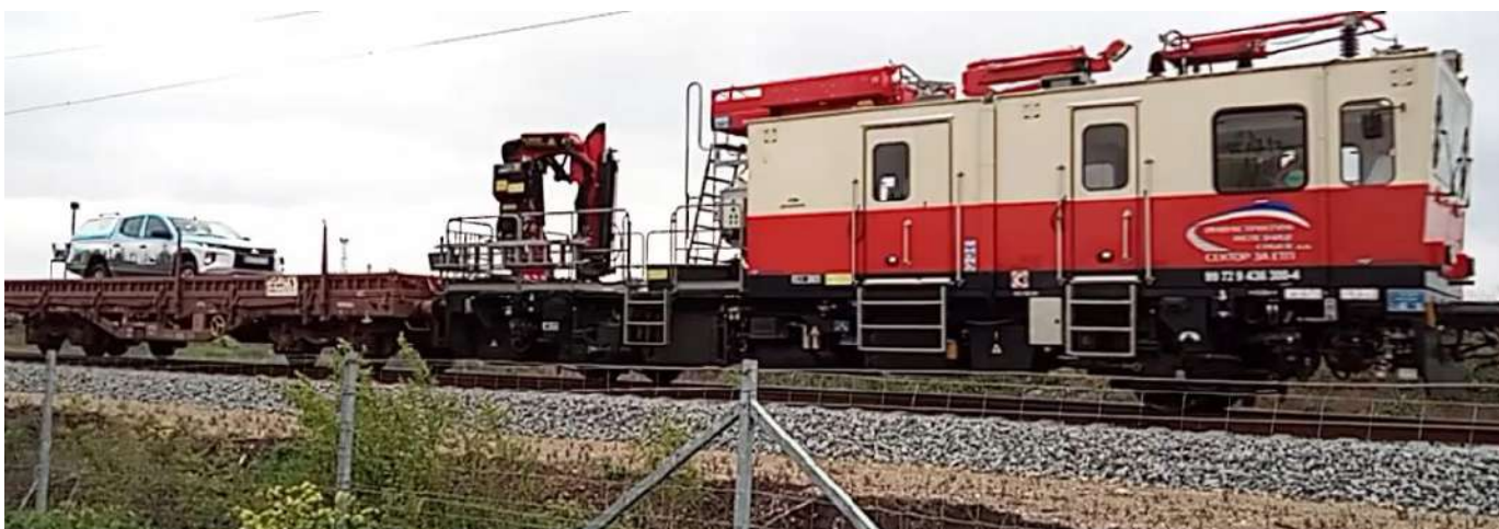
Слика 2. Систем за мобилно мапирање инсталиран на вагон
