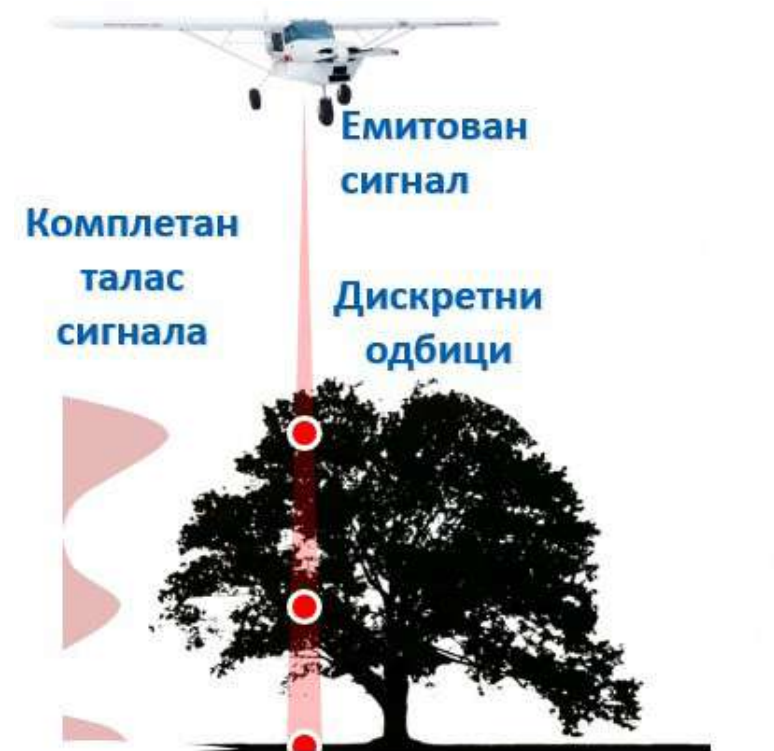
Слика 6. Емисија и рефлексија сигнала у лидар технологији
