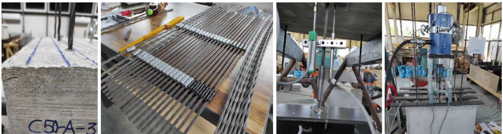
Слика 9. Испитивање иновативног троугаоног ужета
