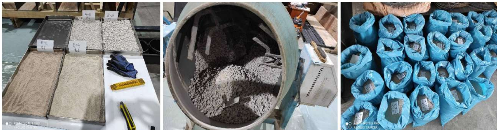
Слика 8. Израда различитих бетонских мјешавина у склопу докторске дисертације на тему испитивања дужине увођења силе у претходно напрегнуте елементе
