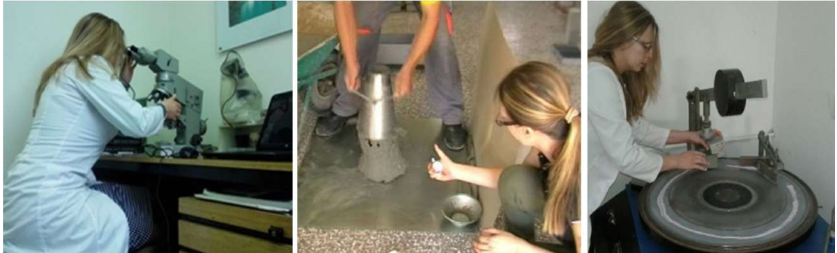
Слика 7. Испитивање трајности самоуграђујућег бетона у функцији примјене врсте агрегата
