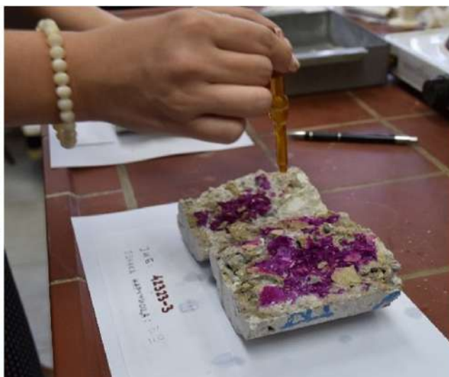
Слика 16. Испитивања уграђеног материјала у АБ конструкцију ХЕ Јајце II – модул Б
