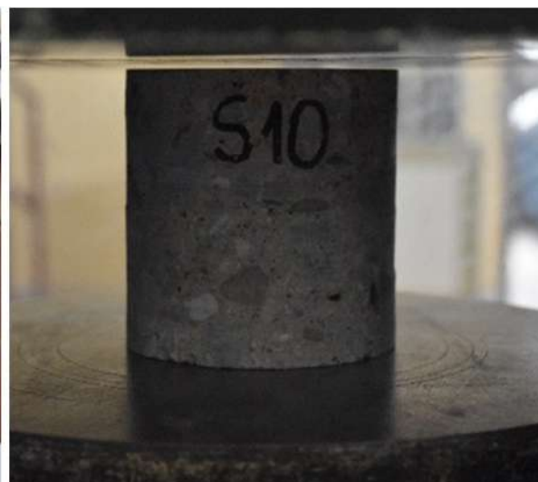
Слика 16. Испитивања уграђеног материјала у АБ конструкцију ХЕ Јајце II – модул Б
