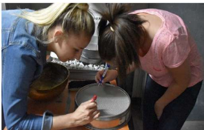
Слика 17. Испитивања у циљу пројектовања рецептура и претходном испитивању бетона система мале хидроелектране Јабланица
