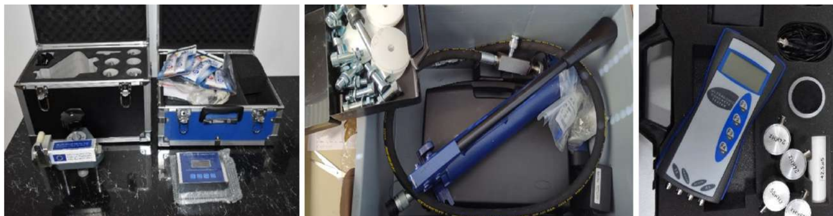
Слика 2. Опрема за испитивање бетона у конструкцијама која одговара стандардима серије BAS EN 12504 испитивање без разарања – одређивање броја одскока, одређивање силе чупања, одређивање ултразвучне брзине
